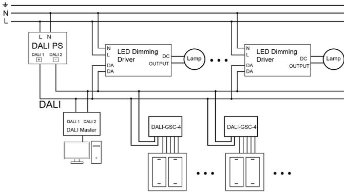
备注：DALI-200只输出DALI控制信号，使用时需增加DALI总线电源DALI-130供电。
